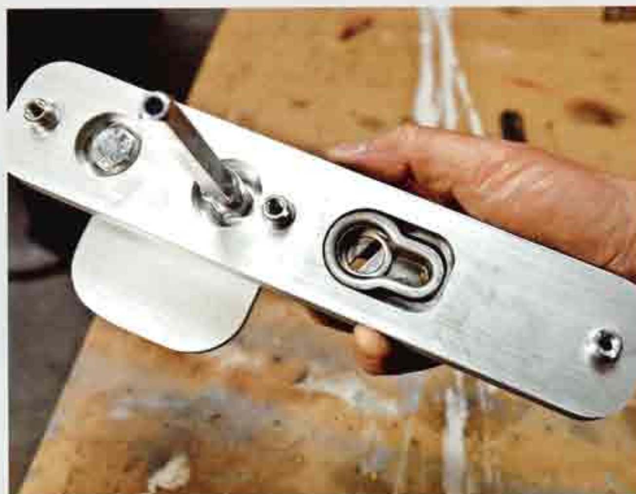
Verstelbare krukstift: dit beslag past op deuren van 38 tot 65 mm dik.
