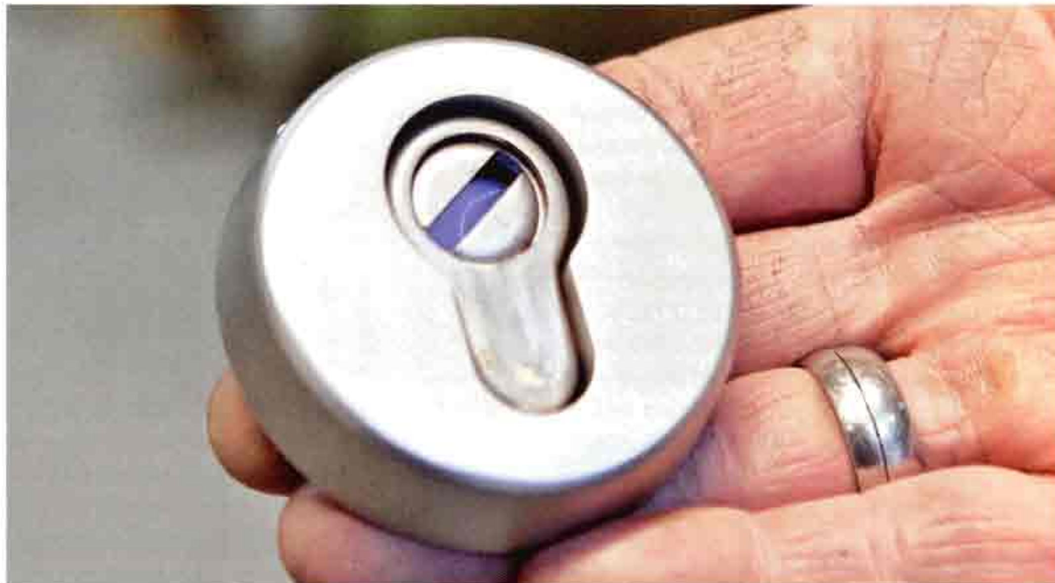
Bij dit rozet houdt een draaibaar afsluitplaatje de cilinder tegen tot 15 Nm trekkracht.
